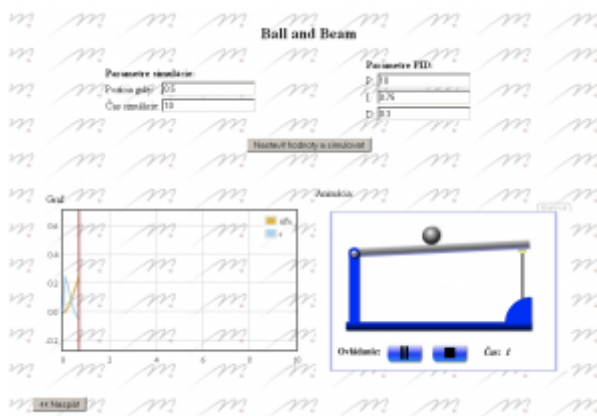
Obr. 8 - OpenModelica - model Beam and Ball - Príklad simulácie pohybu guľičky na tyči na udržanie guľičky na žiadanej pozícii
