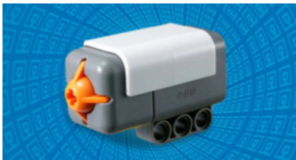
Obr. 8 - dotykový senzor reaguje na dotyk, ak do niečoho narazí a potom uvoľnenie, keď sa odrazí [7]
