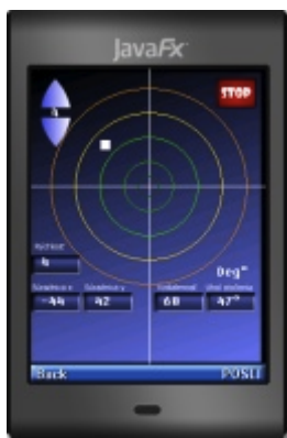
Obr. 3. znázorňuje aplikáciu v položke Control na riadenie vzdialenosti, uhla natočenia a rýchlosti robota
