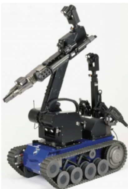
Obr. 7 Záchrannársky robot teleAX.
