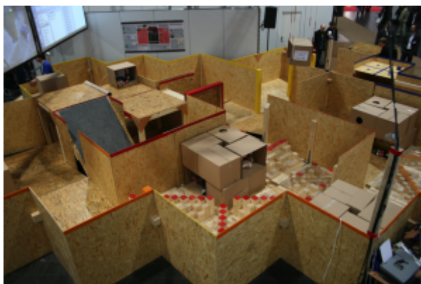
Obr. 6 Testovacie zariadenie pre súťaž RoboCup Rescue.
