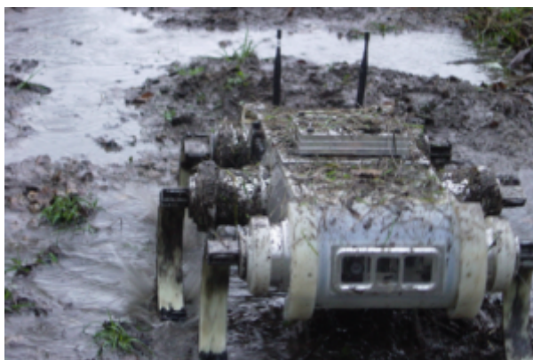
Obr. 3 Záchranársky robot RHex.
