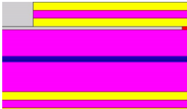
Obr. 5 Detail vrstvy s kvantovými jamami a ohraničujúce vrstvy
