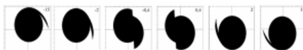
Obr. 2 Množina prvých rezov HP v rovine u_2, i , ilustrujúca zmenu HP s meniacim sa napätím u_1 . Jeho veľkosť je uvedená v pravom hornom rohu.. Čierna resp. biela oblasť odpovedá regiónu príťažlivosti chaotického atraktora resp. stabilného limitného cyklu.
