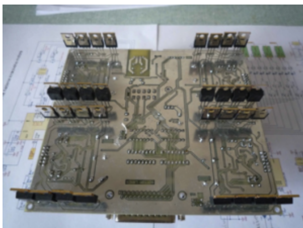
Obr.6P. Elektronika CNC zariadenia, pohľad zo spodnej časti bez chladičov
