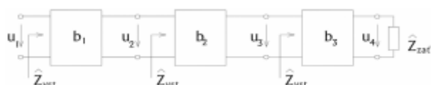
Obr. 2. Zapojenie tlmiacej kaskády deliacich článkov s pevnými deliacimi pomermi b_1 , b_2 , b_3
