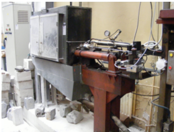
Obr. 2 Vrtná súprava (vrtný stand)
