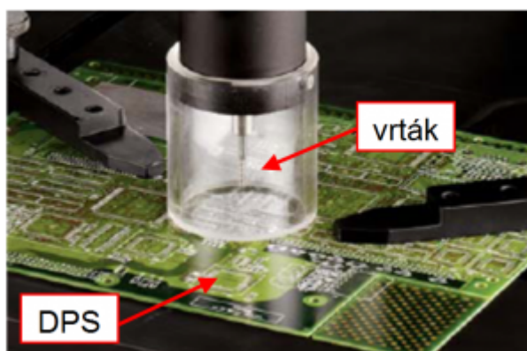
Obr. 2 Drážkovanie DPS počítačom riadenou frézou [2].
