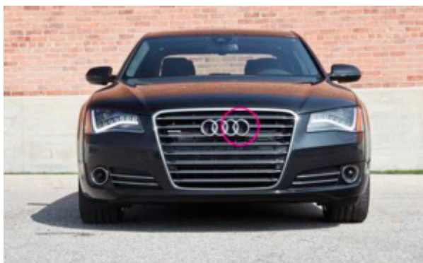
Obrázok 7: Umiestnenie radarového snímača
