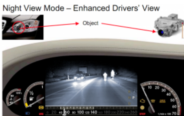
Obrázok 5: Príklad zobrazenia obrazu nasnímaného infračervenou technológiou
