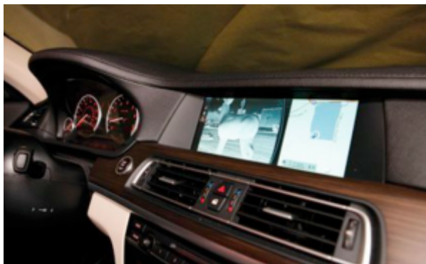
Obrázok 2: TFT displej umiestnený v strede palubnej dosky
