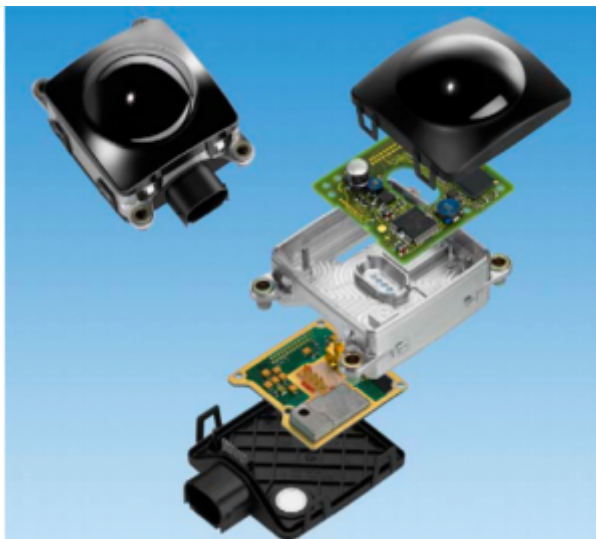
Obrázok 6: Senzor Bosch ACC druhej generácie
