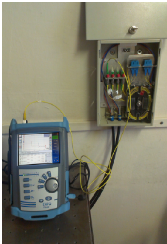
Obr. 8 Meranie OV pomocou optického reflektometra.
