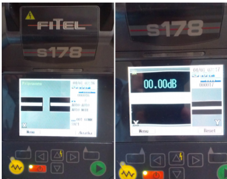
Obr. 6 Zvárací prístroj FITEL S 178.
