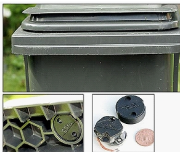
Obr. 1,2. Jeden z príkladov inštalácie RFID tagu na zbernej nádobe (dosah cca 3 m). http://tech.sme.sk , [1]
