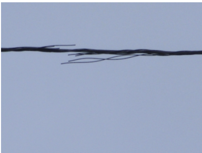
Obr.3 Detail na pretrhnuté pramene na kombinovanom zemnom lane F-501EC-297
