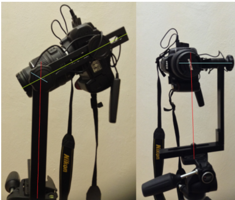
Obr. 3 Vyrobený nástavec zabezpečuje otáčanie aj sklápanie fotoaparátu s objektívom okolo jej optickej osi.
