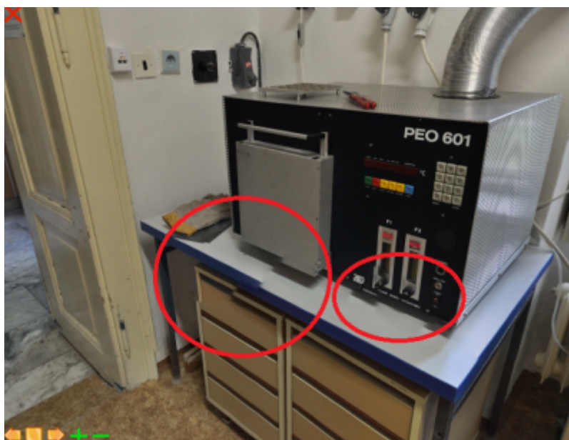
Obr. 2 Znáznornenie deformácií na výslednom panoramatickom obrázku, ktoré vznikli z dôvodu posunutia osi otáčania voči optickej osi.
