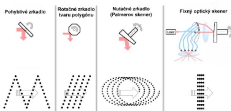
Obr. 1 Najbežnejšie typy skenovacích zariadení používaných systémom LIDAR [7]
