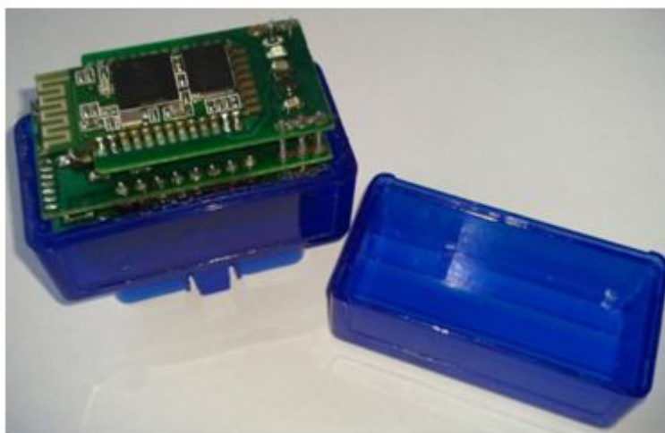
Obr. 10 Palubný počítač na báze OBD2 (otvorený kryt)
