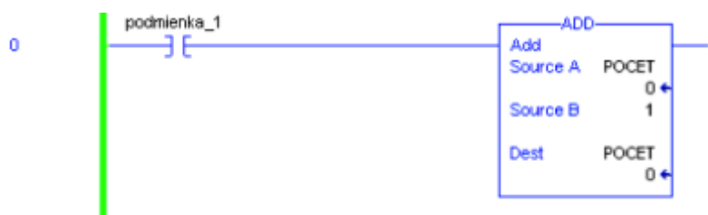
Obr. 1 Príklad inštrukcie ADD v jazyku LD
