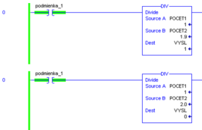
Obr. 6 Realizácia delenia inštrukciou DIV v jazyku LD pre rôzne dátové typy
