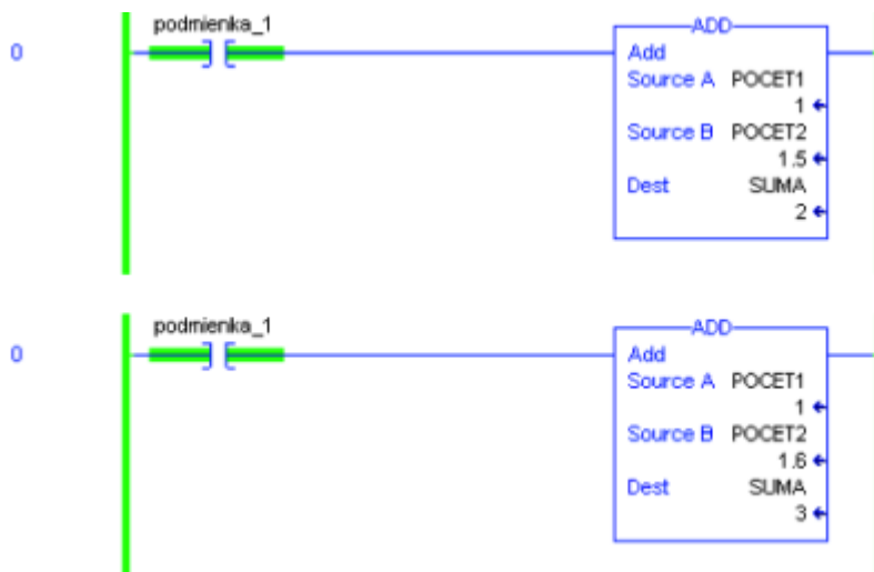
Obr. 2 Príklad inštrukcie ADD v jazyku LD s rôznymi dátovými typmi
