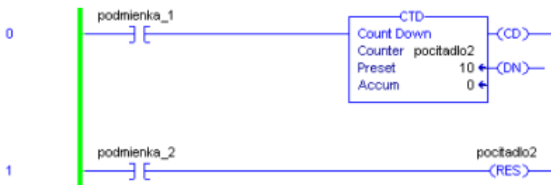
Obr. 6 Ukážka inštrukcie RES v jazyku LD
