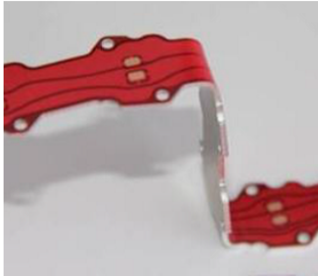
Obr. 9 Príklad tvarovo modifikovateľného IMS substrátu pre priamu aplikáciu.
