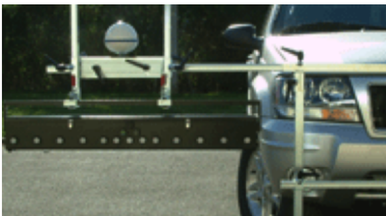
Obr. 4 Nastavenie meracieho rámu na meranie svietivosti nadzemných návěstidiel meracím systémom PAC
