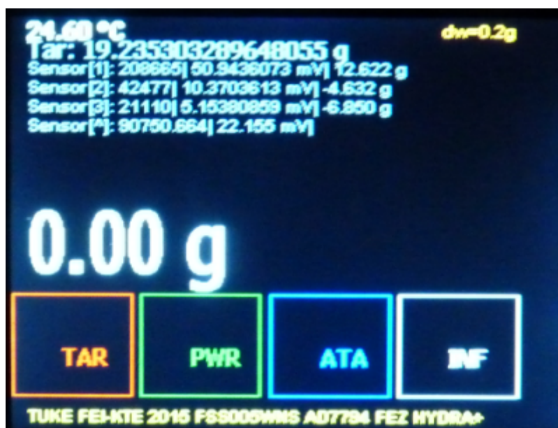
Obr. 7 Zobrazenie doplnkových informácií na dotykovom zobrazovači GHI TE35
