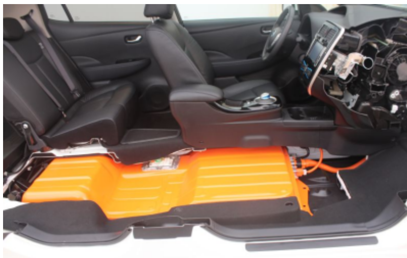
Obr. 18 Umiestnenie akumulátora v automobile Nissan LEAF (Nissan foto)
