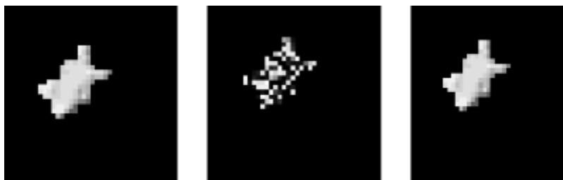
Obr.5 Vľavo reálny segment, v strede segment po priamej zovšeobecnenej DCT s vykonanou Householderovou ortogonalizáciou, vpravo segment po spätnej zovšeobecnenej DCT.
