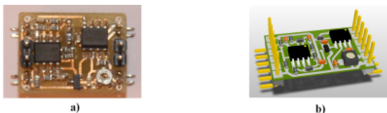
Obr. 16 Blok senzornej časti: a) vrchná strana, b) 3D model v programe Altium Designer [10]
