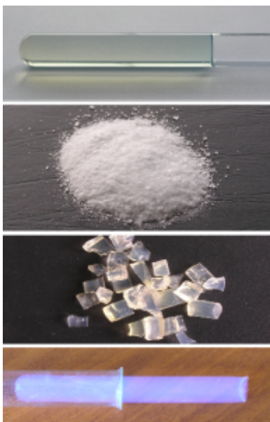
Obr. 6. Vrchný obrázok ukazuje kremičitý gél s vysokým obsahom metanolu. Ďalšie obrázky (v smere zhora nadol) ukazujú: kryogél, xerogél a aerogél. Vidno, že až na aerogél, sú produkty sušenia tvarovo výrazne zmenené
