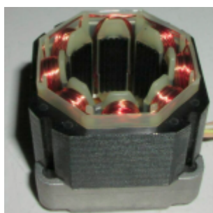
Obr. 2. Krokový motor: b) statorová časť
