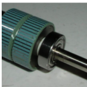
Obr. 2. Krokový motor: c) rotor
