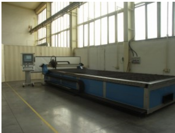
Obr. 3. Plazmový rezací stroj s riadiacim systémom na platforme Linux - RTAI
