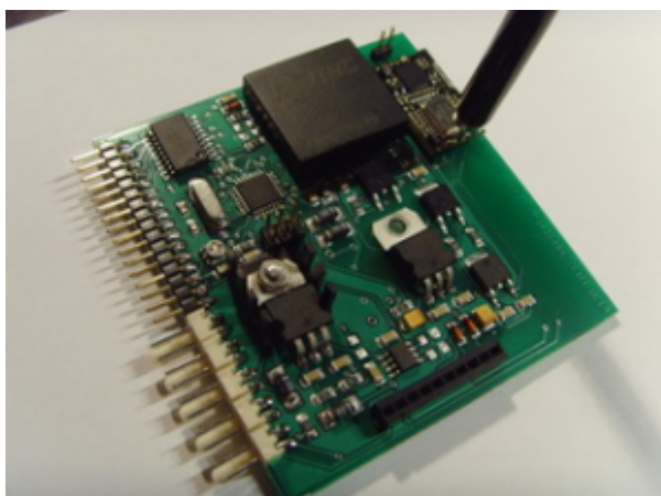
Obr. 9. V spodnej časti sa nachádza konektor pre pripojenie bezdotykového ovládacieho terminálu.
