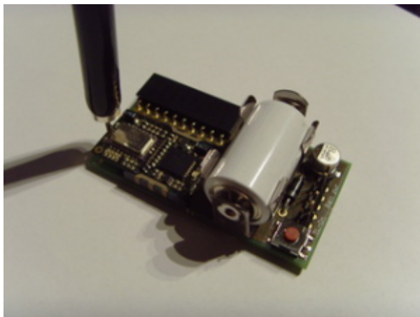
Obr. 8. Modul IQRF ako bezdrôtový teplomer
