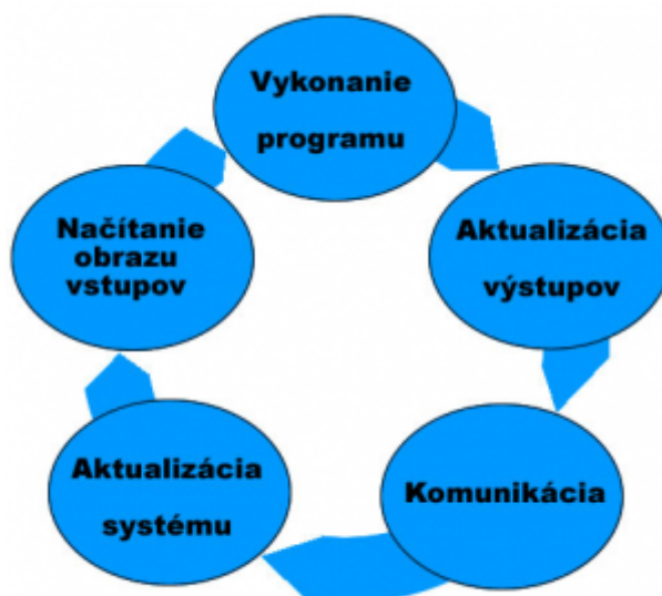
Obr. 4: Zjednodušený operačný cyklus procesora
