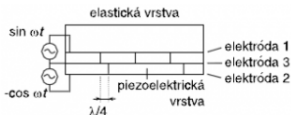
Obr. 6. Štruktúra piezoelektrického meniča.
