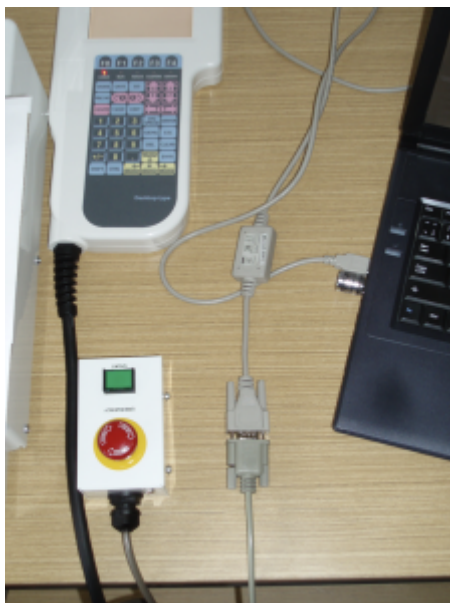
Obr. 3: Spojené sériové porty počítače a robota.
