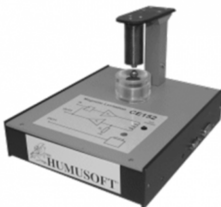
Obr. 3. Reálny model magnetickej levitácie
