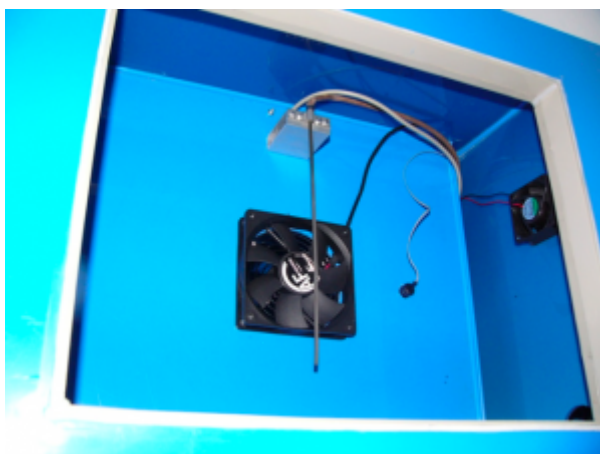
Obr. 9. Umístění topného tělesa
