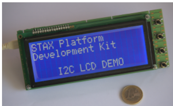
Obr. 8. Modul displeja osadený najväčším znakovým 4×20 displejom BC2004B a štyrmi bočnými tlačítkami
