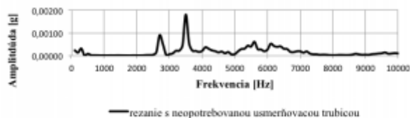
Obr. 5 Obálka frekvenčného spektra vibrácií na technologickej hlavici neopotrebovanou usmerňovacou trubicou pre zrnitosť abrazíva MESH 50
