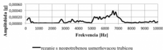
Obr. 9 Obálka frekvenčného spektra vibrácií na technologickej hlavici neopotrebovanou usmerňovacou trubicou pre zrnitosť abrazíva MESH 120
