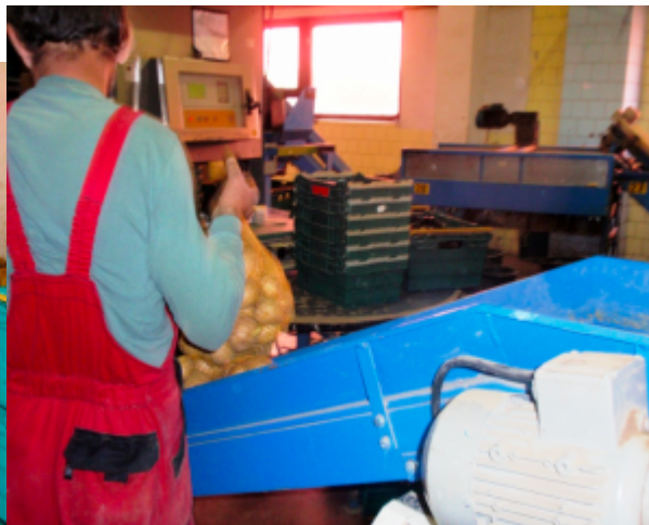
Obr. 27 DAUMAR - iný typ balenia na rašlové vrecia pre prané zemiaky
