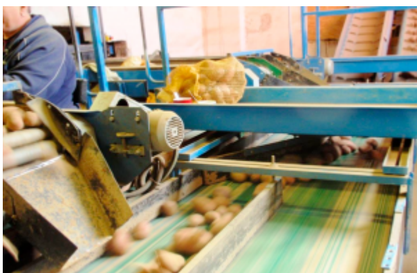
Obr. 18 Jeden zo štyroch preberacích stolov a dopravníkov vedúce do zásobníkov
