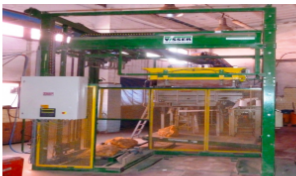
Obr. 22 Paletizér pre ukladanie 25 kg vriec zemiakov
