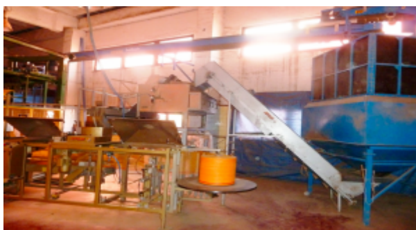
Obr. 21 Hala č. 3 zásobník, automatická váha a balička AFFELDT
