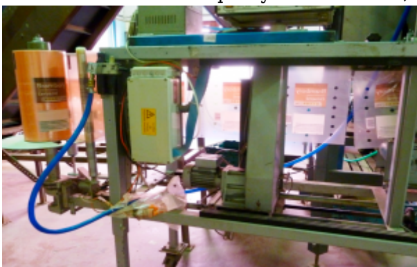
Obr. 27 DAUMAR - iný typ balenia na rašlové vrecia pre prané zemiaky
