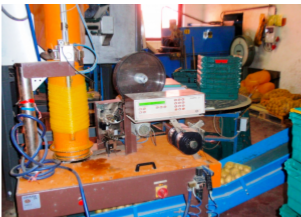
Obr. 27 DAUMAR - iný typ balenia na rašlové vrecia pre prané zemiaky
