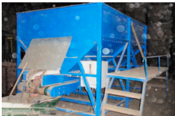
Obr. 16 Presun zemiakov z paliet do príjmového zásobníka
