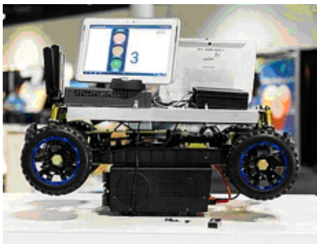
Obr. č. 6. Ilustrácia systému replikujúceho semafor na displej vodiča []
