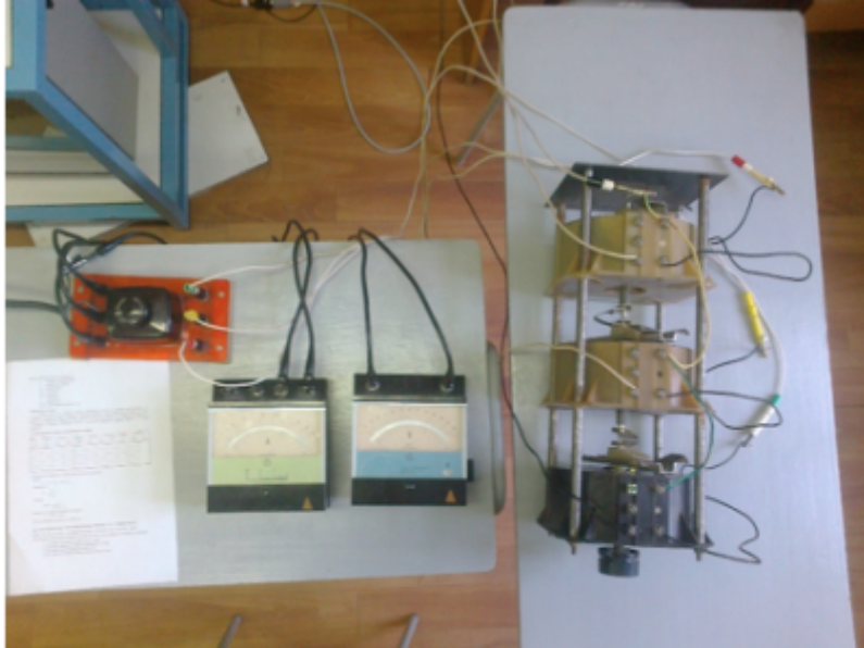
Obr.7 Detail zapojenia pre skúšku synchronného generátora sklzovou metódou
