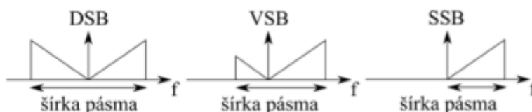
Obr. 2 Porovnanie spektier signálov DSB, VSB a SSB
