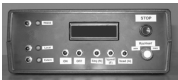
Obr. 7. Ovládací panel meniča
